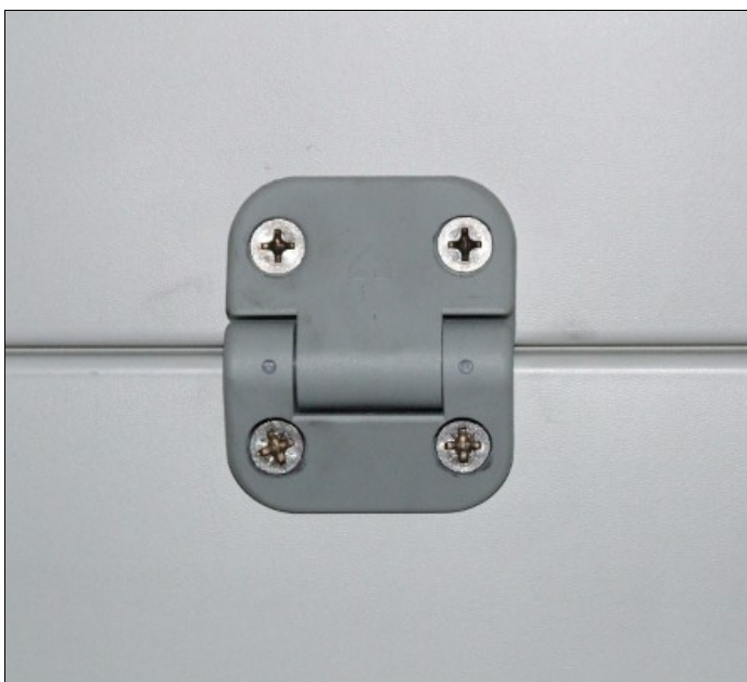
Alle Montagebohrungen der Scharniere müssen exakt positioniert werden, damit die Sektionen dicht schließen. So bleibt die Tiefkühlware auch im Sommer beim Transport gefroren.
