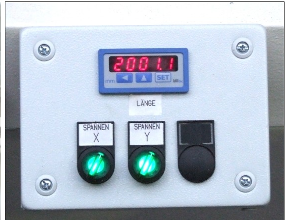
Der Maschinenbediener bekommt die Länge der Sektion angezeigt und kann sie bei Abweichungen von der Toleranz aussortieren.
